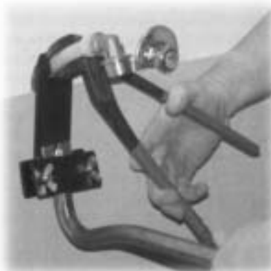
Рисунки 53-56: Замена поврежденной трубы
