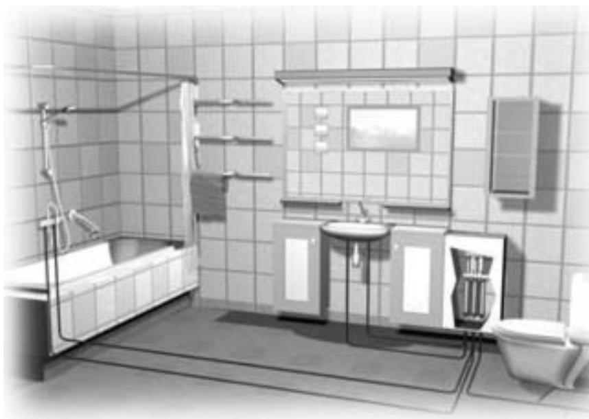
Рисунок 9: Коллекторная система с 10 соединениями
