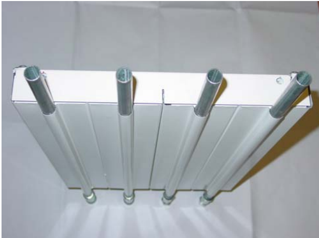
Рис.7 Стандартное исполнение. Оптимальная теплоотдача достигается при помощи плотной запрессовки труб в излучающий стальной экран.
