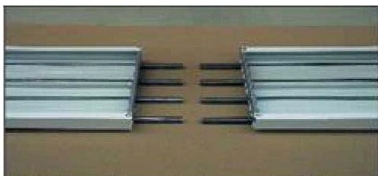
Рис.78 Проверить, нет ли на концах труб царапин, загрязнений или деформаций.
