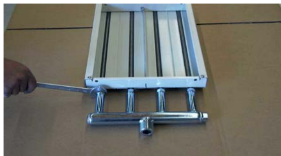
Рис.77 Затянуть накидную гайку до упора гаечным ключом, сделав 1 1/2 оборота.
