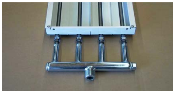
Рис.75 Вставить коллектор до упора. При этом зажимное кольцо должно прилегать к скошенной стороне резьбового крепления.
