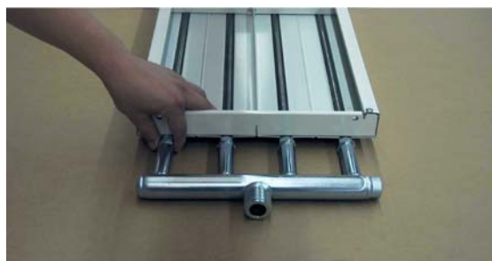
Рис.76 Затянуть рукой накидную гайку.
